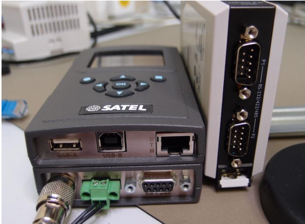
Рисунок 4. Внешний вид разъемов на радиомодеме SATELLAR и преобразователе MOXA.
