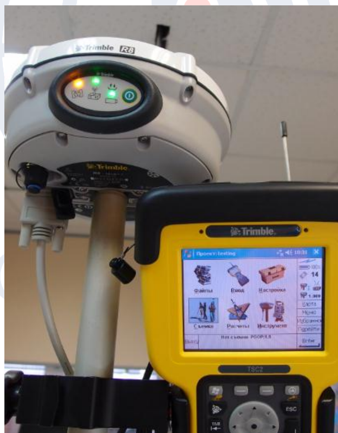
Рисунок 8. Получение приемником потока поправок по радиоканалу.
