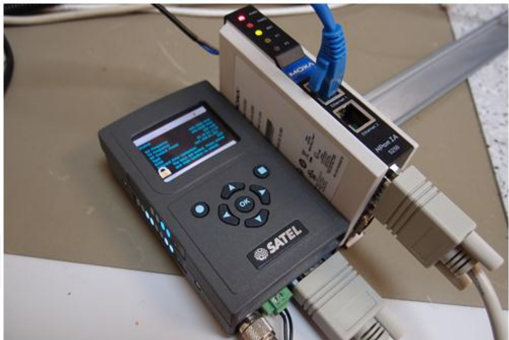
Рисунок 5. Соединение радиомодема с преобразователем MOXA.
